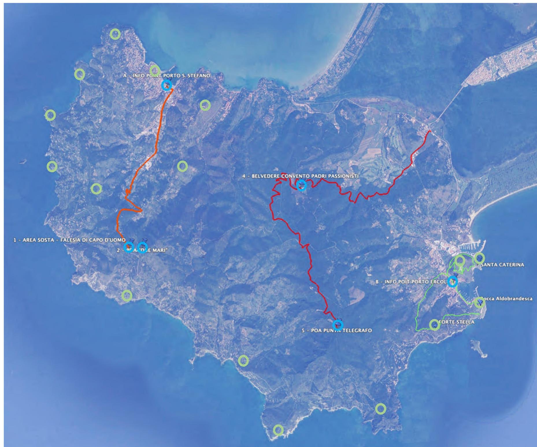
Fig. E.04 – In rosso la viabilità principale di accesso alle risorse, in azzurro le aree oggetto dei piccoli interventi di valorizzazione e in verde le principali evidenze architettoniche
